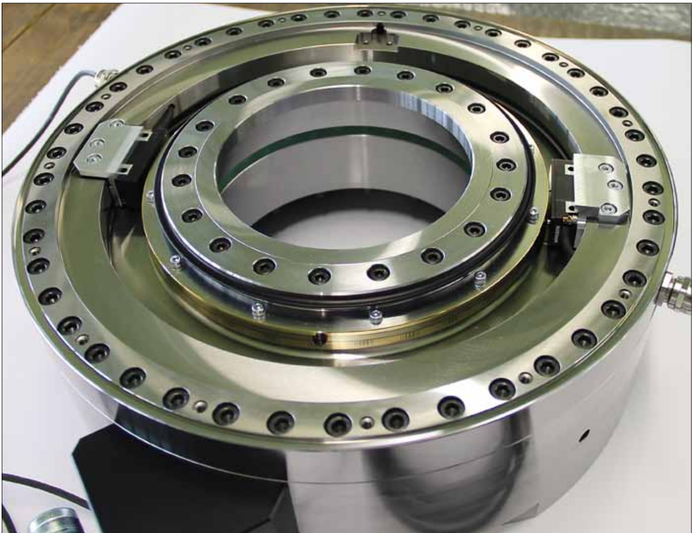
Hier deutlich zu sehen: die beiden um 180 Grad versetzten Abtastköpfe des Winkelmessgeräts von Heidenhain.
