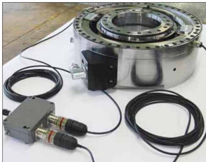
Diesen wassergekühlten Rundtisch hat Schüssler-Technik an die Firma Lang geliefert. Im Vordergrund ist die Interface-Box von Heidenhain zu sehen.
